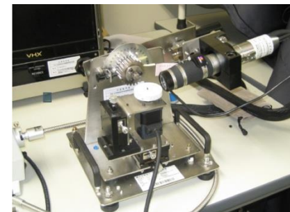
顕微鏡による3次元CADモデル復元装置
