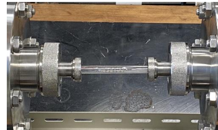
熱誘導流れのひとつである熱ほふく流を利用したポンプシステム
